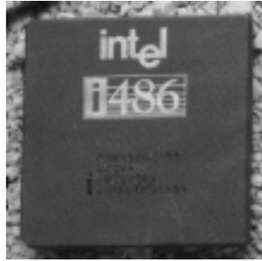
Figura 11 - Microprocessador 80486
