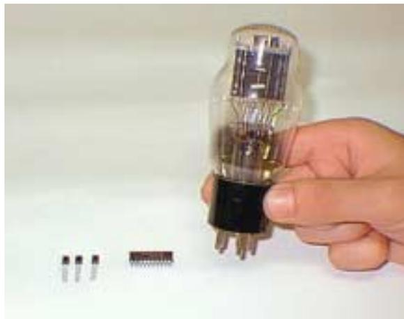
Figura 5 - Transistores, Chip e Válvula.
